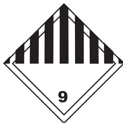
Figura 116 Rotulagem de produtos da Classe 9
