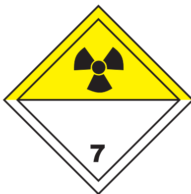
Figura 114 Rotulagem de produtos radioativos
