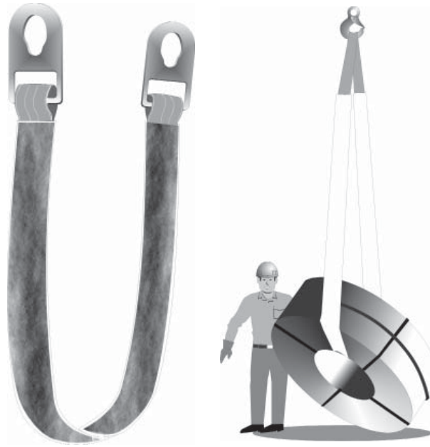
Figura 37 1) Cinta de poliéster para elevação de cargas. 2) Cinta movimentando bobina com proteção para canto vivo
